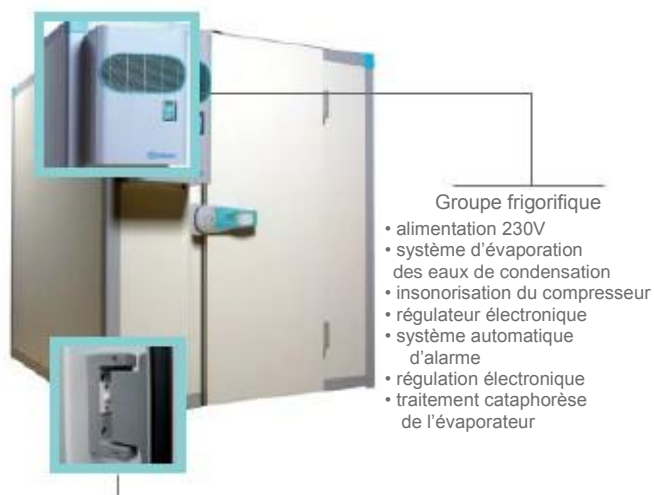
Charnière à contact permet l'arrêt du groupe et l'éclairage de la chambre lors de l'ouverture de la porte.
